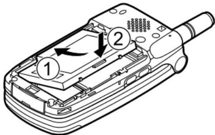
4. Schließen Sie den Akkufachdeckel, indem Sie die Markierungen aneinander ausrichten und den Deckel an seine Ausgangsposition schieben.
