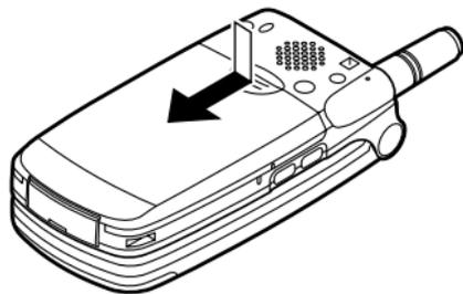
2. Pegue na bateria utilizando a extremidade saliente e retire a bateria do telefone.
