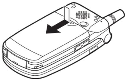
2. 從突出的邊緣將電池從手機中取出。
